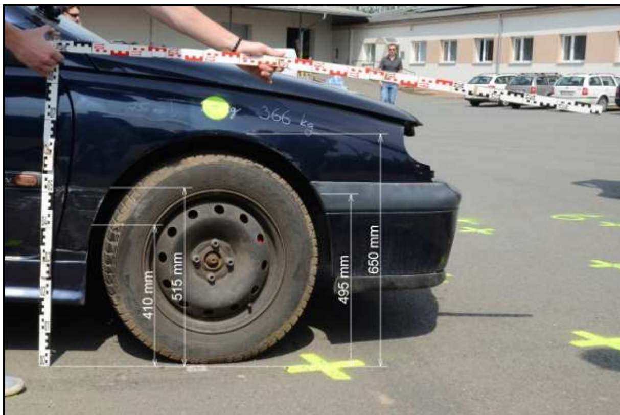
Obr. 9 Detailní boční pohled na poškození přední části stojícího vozidla experimentu 1
