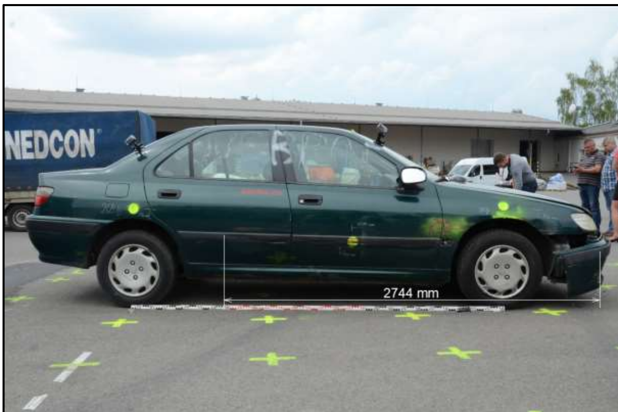
Obr. 21 Boční pohled na délkový rozsah poškození stojícího vozidla experimentu 3
