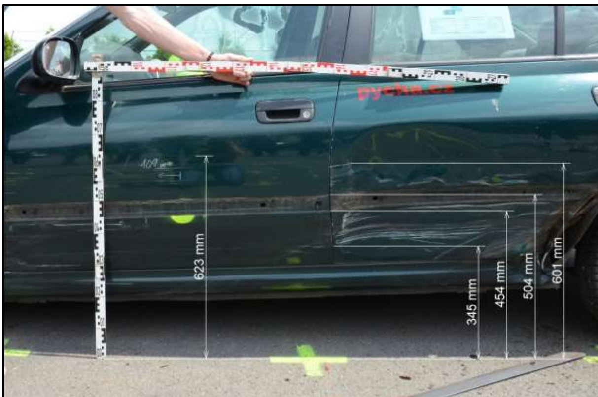
Obr. 28 Detailní boční pohled na poškození střední části stojícího vozidla experimentu 4
