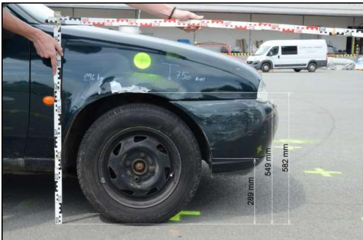
Obr. 12 Detailní boční pohled na poškození přední části narážejícího vozidla experimentu 2
