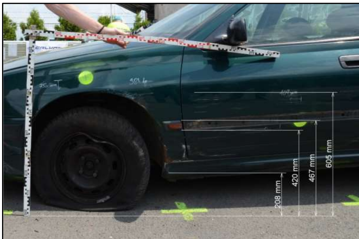
Obr. 27 Detailní boční pohled na poškození přední části stojícího vozidla experimentu 4
