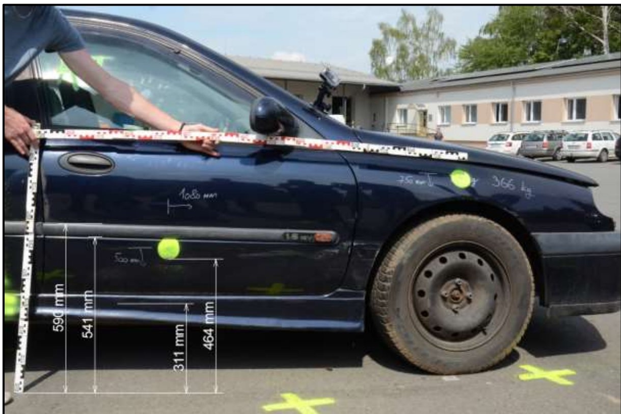
Obr. 8 Detailní boční pohled na poškození střední části stojícího vozidla experimentu 1
