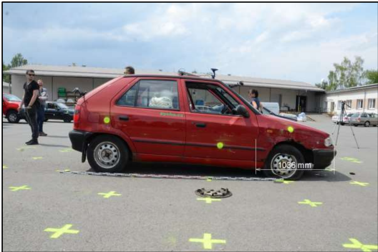
Obr. 24 Boční pohled na délkový rozsah poškození nárazejícího vozidla experimentu 4
