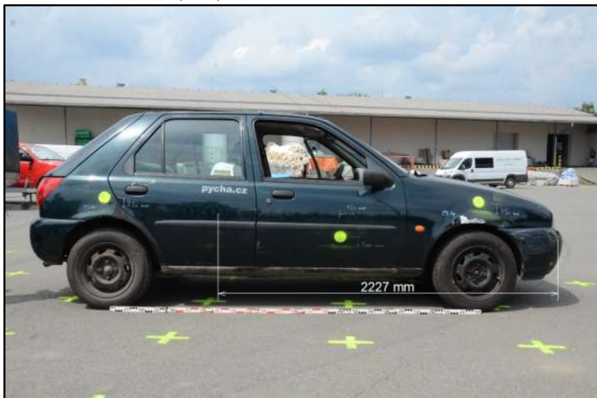
Obr. 10 Boční pohled na délkový rozsah poškození nárazejícího vozidla experimentu 2
