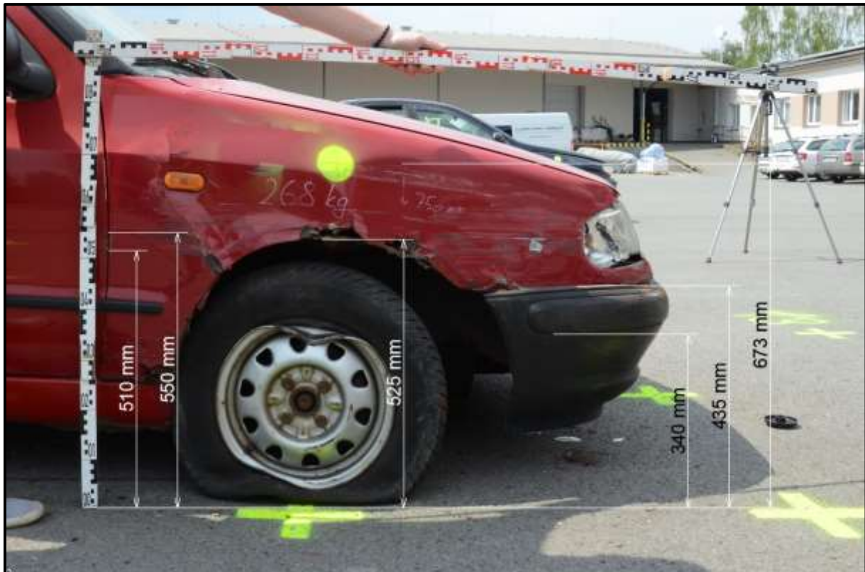
Obr. 25 Detailní boční pohled na poškození přední části nárazejícího vozidla experimentu 4
