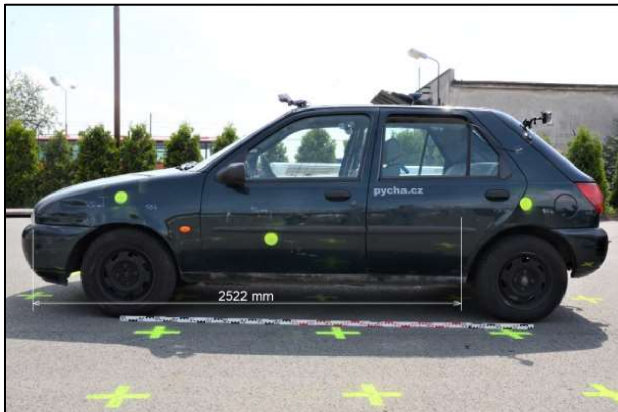
Obr. 3 Boční pohled na délkový rozsah poškození narážejícího vozidla experimentu 1
