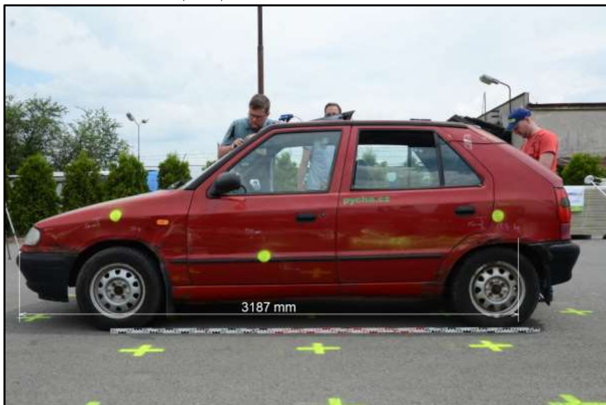
Obr. 17 Boční pohled na délkový rozsah poškození nárazejícího vozidla experimentu 3
