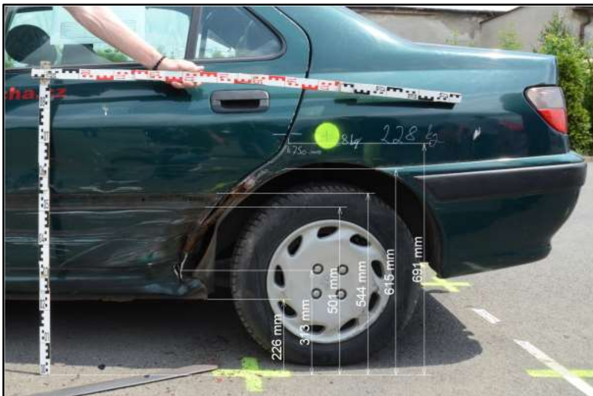
Obr. 29 Detailní boční pohled na poškození zadní části stojícího vozidla experimentu 4
