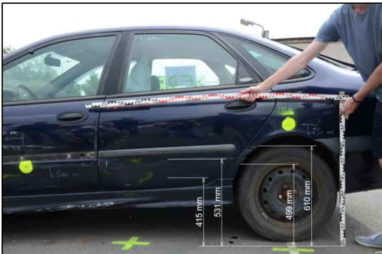
Obr. 14 Detailní boční pohled na poškození střední části stojícího vozidla experimentu 2
