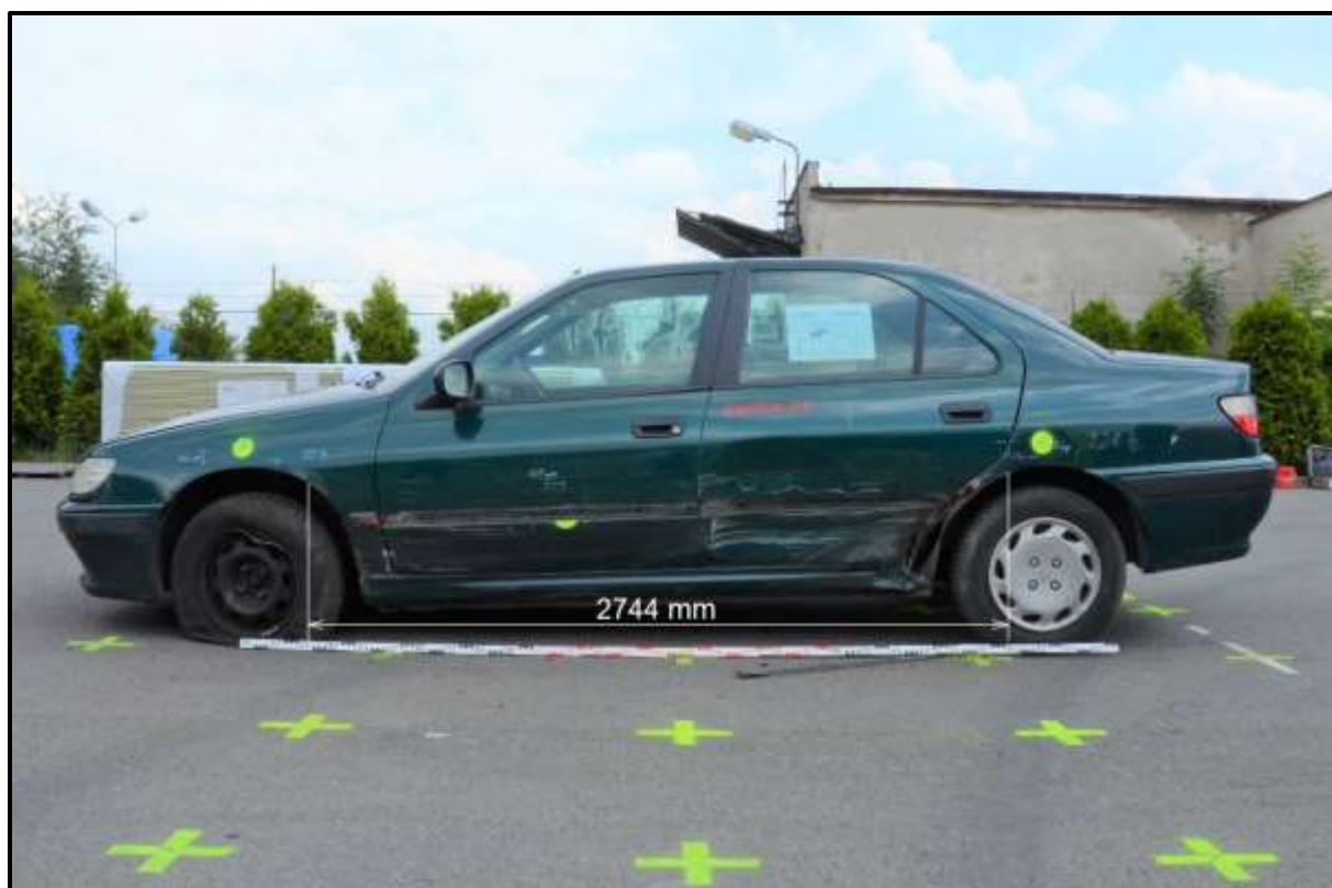
Obr. 26 Boční pohled na délkový rozsah poškození stojícího vozidla experimentu 4
