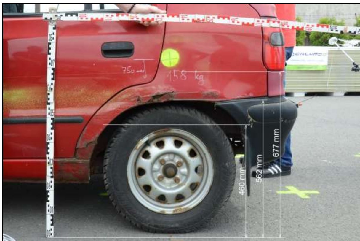
Obr. 20 Detailní boční pohled na poškození zadní části nárazejícího vozidla experimentu 3
