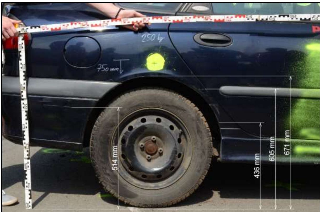
Obr. 7 Detailní boční pohled na poškození zadní části stojícího vozidla experimentu 1
