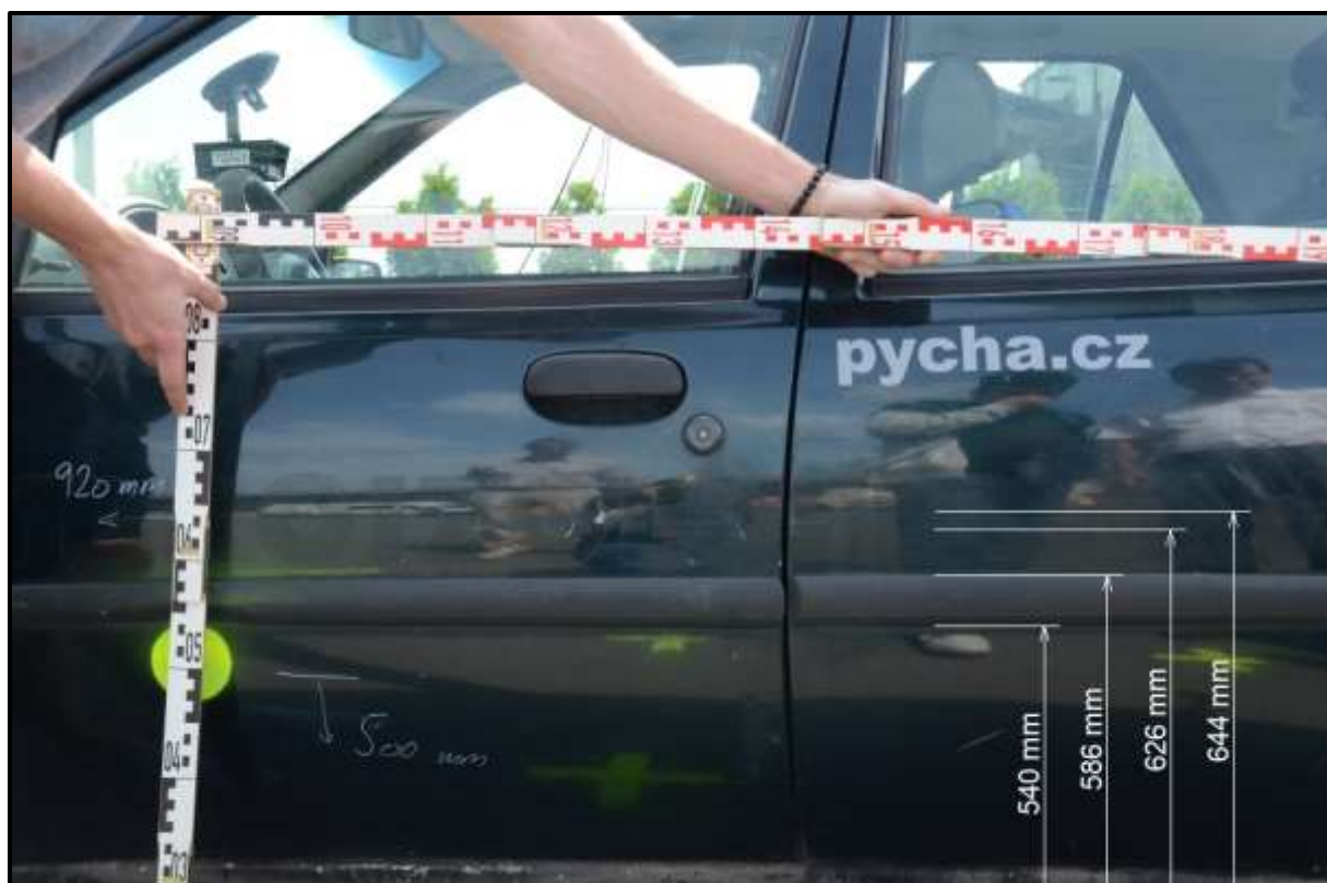
Obr. 5 Detailní boční pohled na poškození střední části narážejícího vozidla experimentu 1
