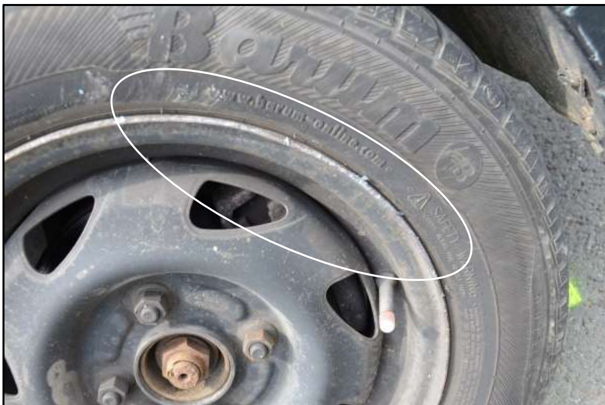
Obr. 16 Otěr barvy a laku na disku kola vozidla Ford Fiesta
