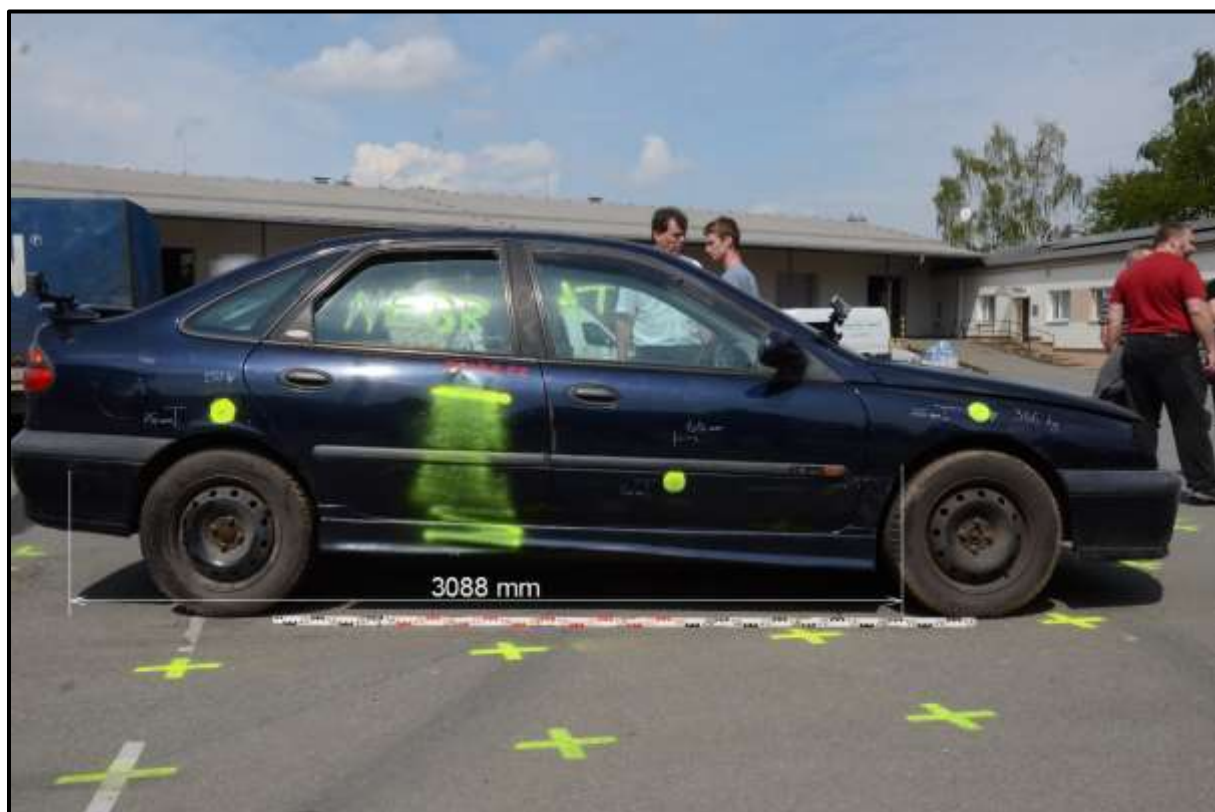
Obr. 6 Boční pohled na délkový rozsah poškození stojícího vozidla experimentu 1
