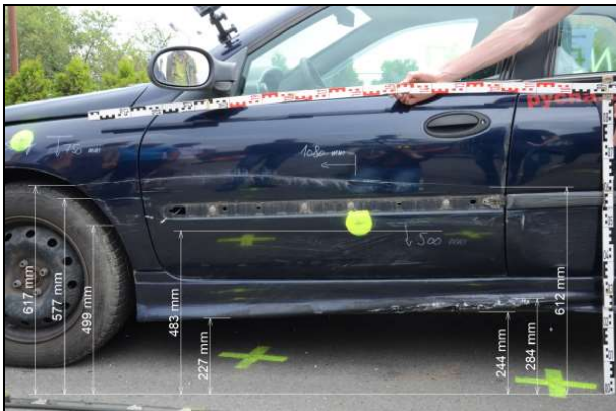
Obr. 15 Detailní boční pohled na poškození střední až přední části stojícího vozidla experimentu 2
